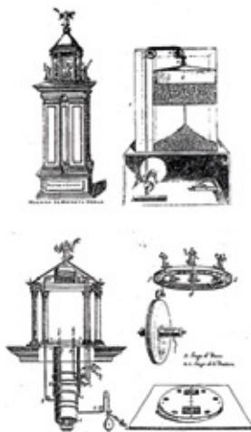
Herón de Alejandría, según Bernardino Baldi: despiece de la máquina automática móvil, en De gli Automati, overo Machine se moventi , Venecia 1589.
