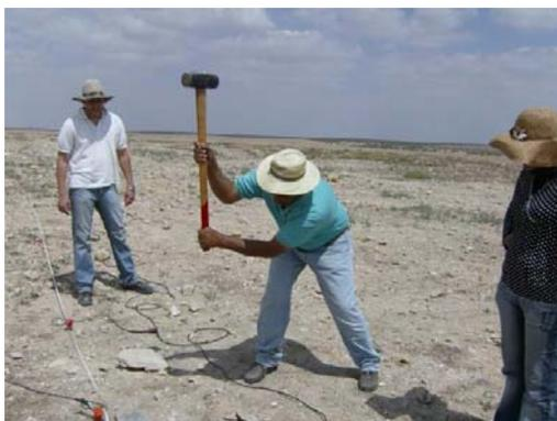
Martillo sísmico generador de energía incidente
