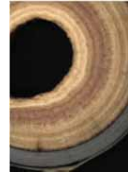
Incrustaciones de calcita: \text{CaCO}_3
