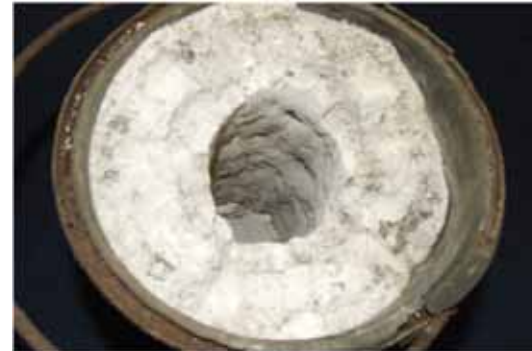
Incrustaciones de estruvita: \text{MgNH}_4\text{PO}_4 \cdot 6\text{H}_2\text{O}
