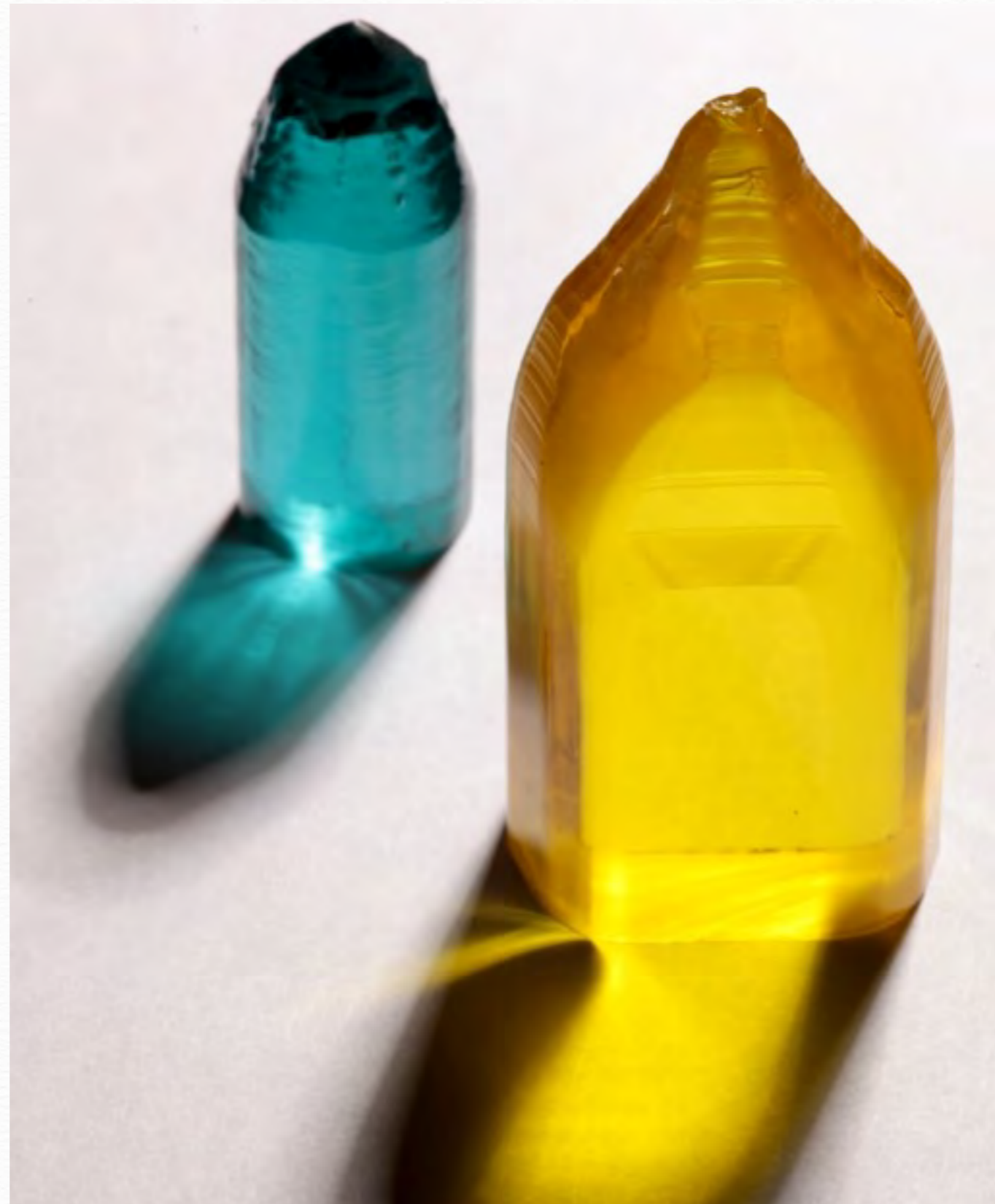
Monocristales de óxidos para láseres o substratos de superconductores de alta temperatura
