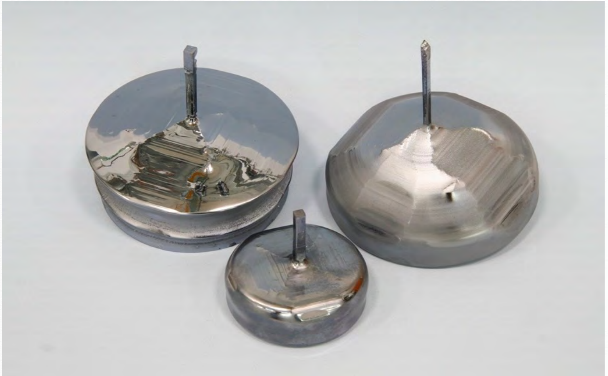
Monocristales de arseniuro de galio para dispositivos electrónicos de alta frecuencia
